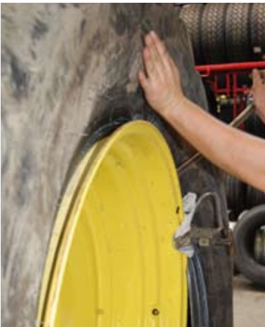
Afb. 20: band goed in het diepbed drukken
