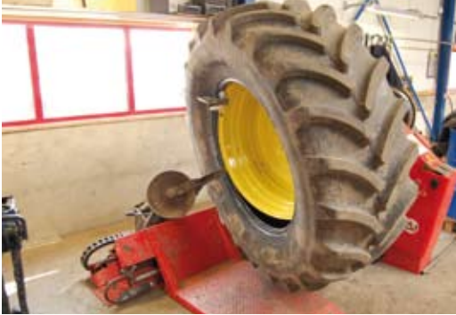
Afb. 19: hielklem monteren en band draaien
