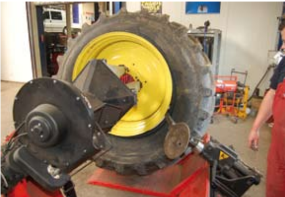
Afb. 9: tweede hiel verwijderen
