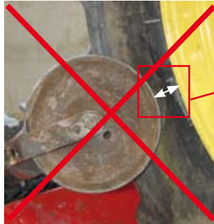
Afb. 6: rol is niet goed geplaatst. De afstand tussen de rol en de velgrand is te groot
