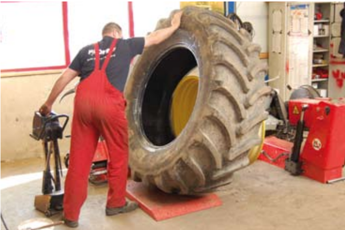
Afb. 17: band optillen in diepbed
