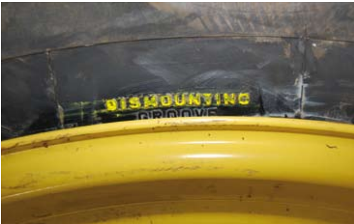
Afb. 27: Plaats voor montage hieldrukker
