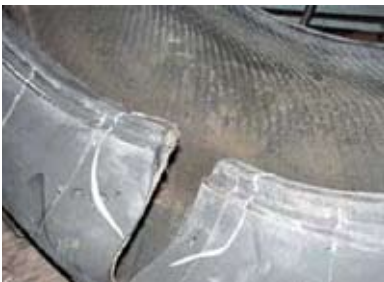
Afb. 42: band met grote kracht over veiligheidsrib gesprongen
