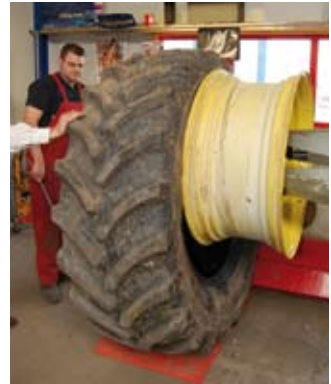
Afb. 10: pas op dat de band niet omvalt
