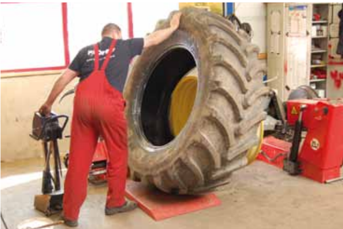
Afb. 17: band optillen in diepbed
