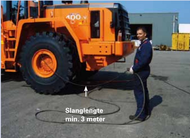
Afb. 40: op voorspanning brengen
