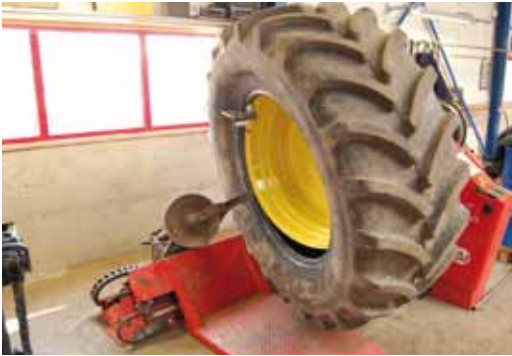
Afb. 19: hielklem monteren en band draaien
