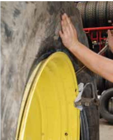
Afb. 20: band goed in het diepbed drukken
