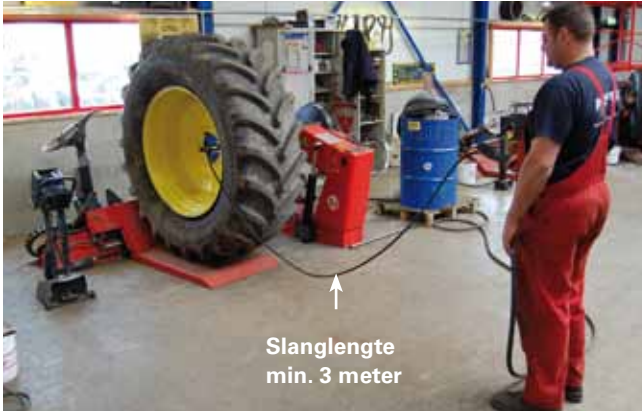
Afb. 35: veilige plaats bij het aanbrengen van de voorspanning
