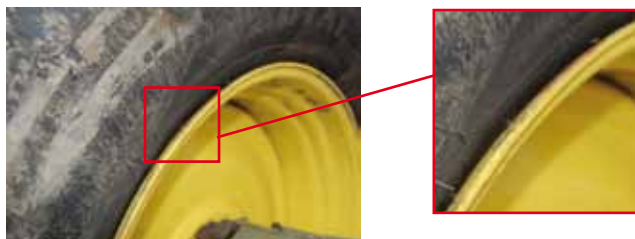
Afb. 37: hiel nog niet volledig gezet bij 1 bar voorspanning
