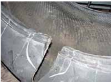
Afb. 42: band met grote kracht over veiligheidsrib gesprongen
