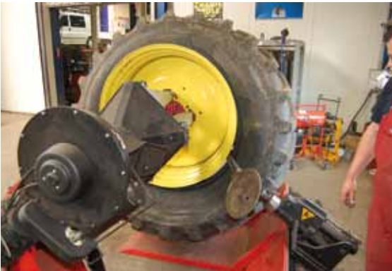
Afb. 9: tweede hiel verwijderen
